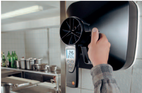
Kontrolle der Abluft an einem Aufputzlüfter
